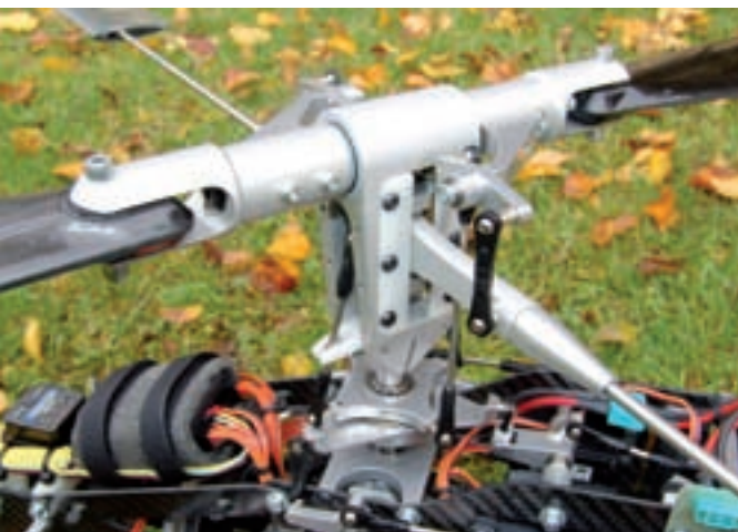
Der Paddelkopf macht vor dem Umbau einen recht massiven Eindruck und hat viele beweglich Teile
