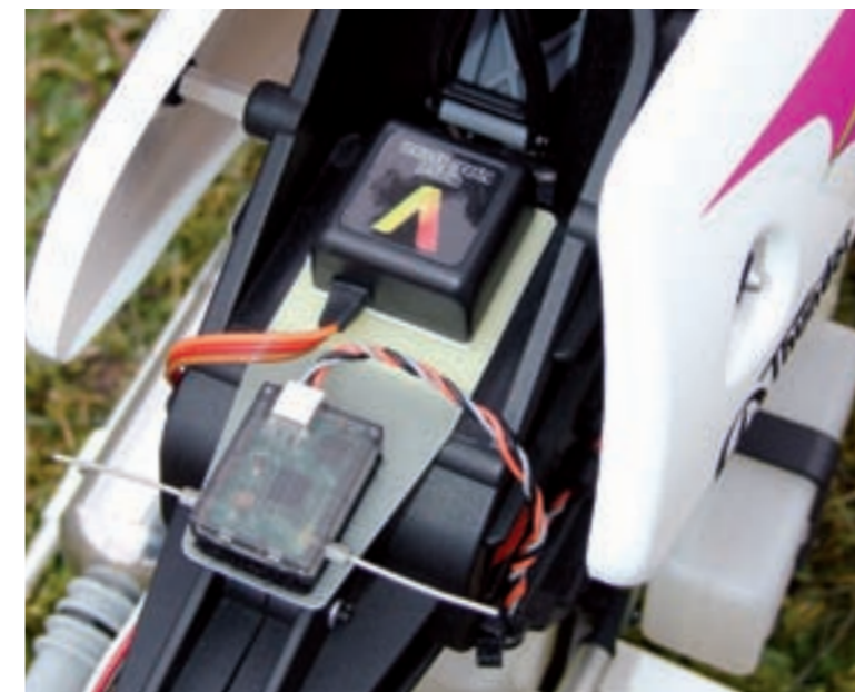
Die Befestigung des Sensors erfolgt an gewohnter Stelle. Der Abgang des Kabels ist strikt einzuhalten (entweder nach vorne oder nach hinten), um die richtige Lage der Sensoren zu garantieren
