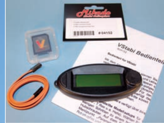
Das Bedienteil ermöglicht ein Verändern der Einstellparameter auf dem Flugplatz ohne PC
