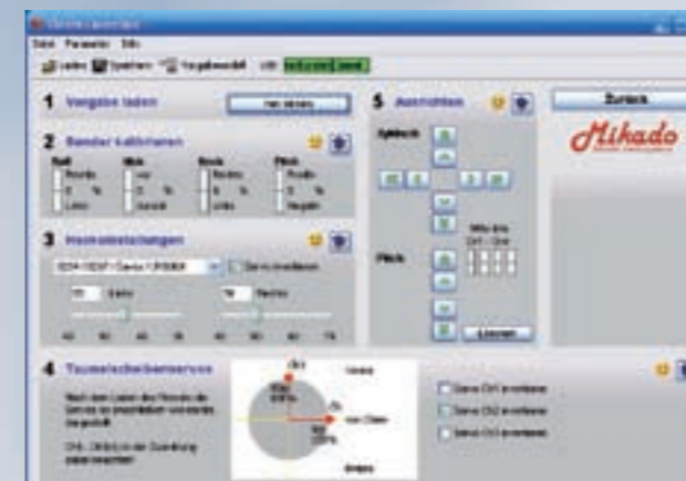
Aktiviert man das Setup-Menü, ist der Regelkreis deaktiviert und die mechanischen Einstellungen können am Modell vorgenommen werden
