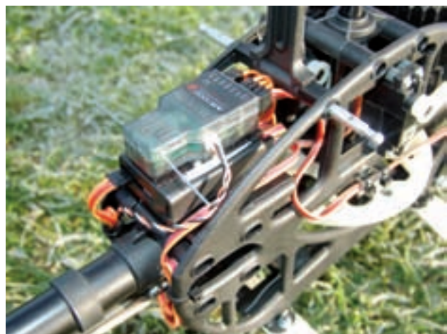
Der Empfänger sitzt Huckepack auf der V-Stabi-Elektronikbox. Nach hinten geht die Steckbuchse für den Sensor ab, direkt darüber der Eingang für das Bedienpanel
