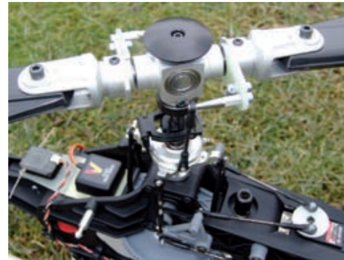
So präsentiert sich der umgebaute Rotorkopf auf dem Raptor 50: Die Anlenkarme wurden verlängert und der Mitnehmer von Hirobo dreht den Innenring der Taumelscheibe
