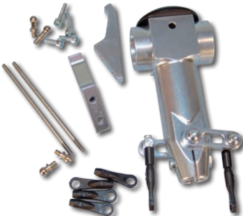
So kommt das flybarless-Umrüstset von Jan Henseleit. Man beachte die direkt am Zentralstück angebrachten, kugelgelagerten Mitnehmerarme. Clever: Das kleine Loch im Zentralstück dient nach dem Durchschieben der alten Paddelstange als Justierhilfe
