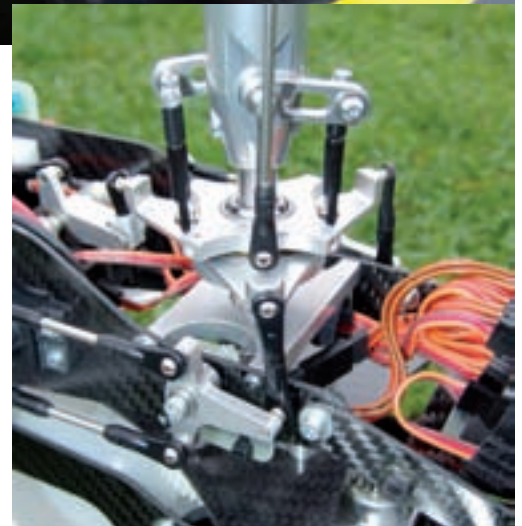
Einfacher und präziser geht es nicht: Die Arme des Taumelscheiben-Mitnehmers sind mit je vier Kugellagern bestückt
