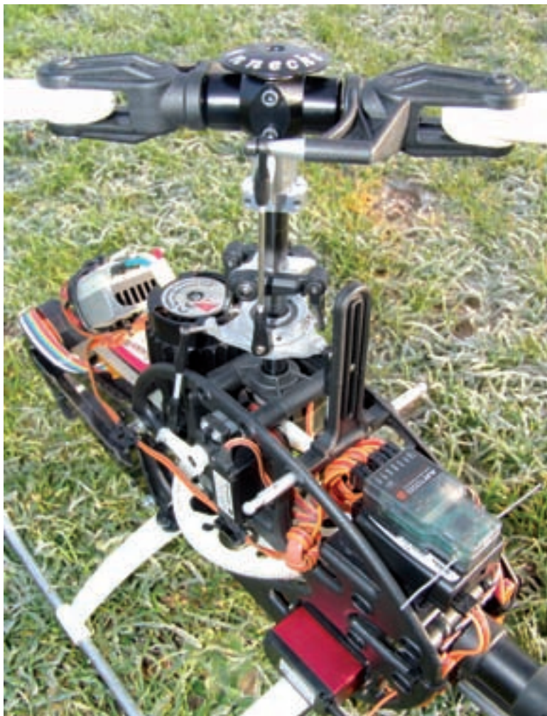
So simpel sieht der Rotorkopf nach dem Umbau auf V-Stabi aus. Verlängerungen an den Blattgriffen bringen die Anlenkpunkte auf die Mitte des Zentralstücks
